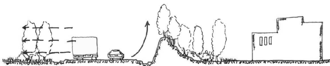
Esempio di effetto di attenuazione determinato dalle fasce di vegetazione associate anche alla formazione di terrapieni (in particolare per le aree prossime ad edificato residenziale esistente o in progetto)
